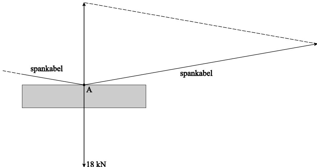
In de figuur komt 1 cm overeen met 5 kN. De lengte van de vector van de spankracht is 10,5 cm, zodat de grootte van de spankracht gelijk is aan 53 kN.
